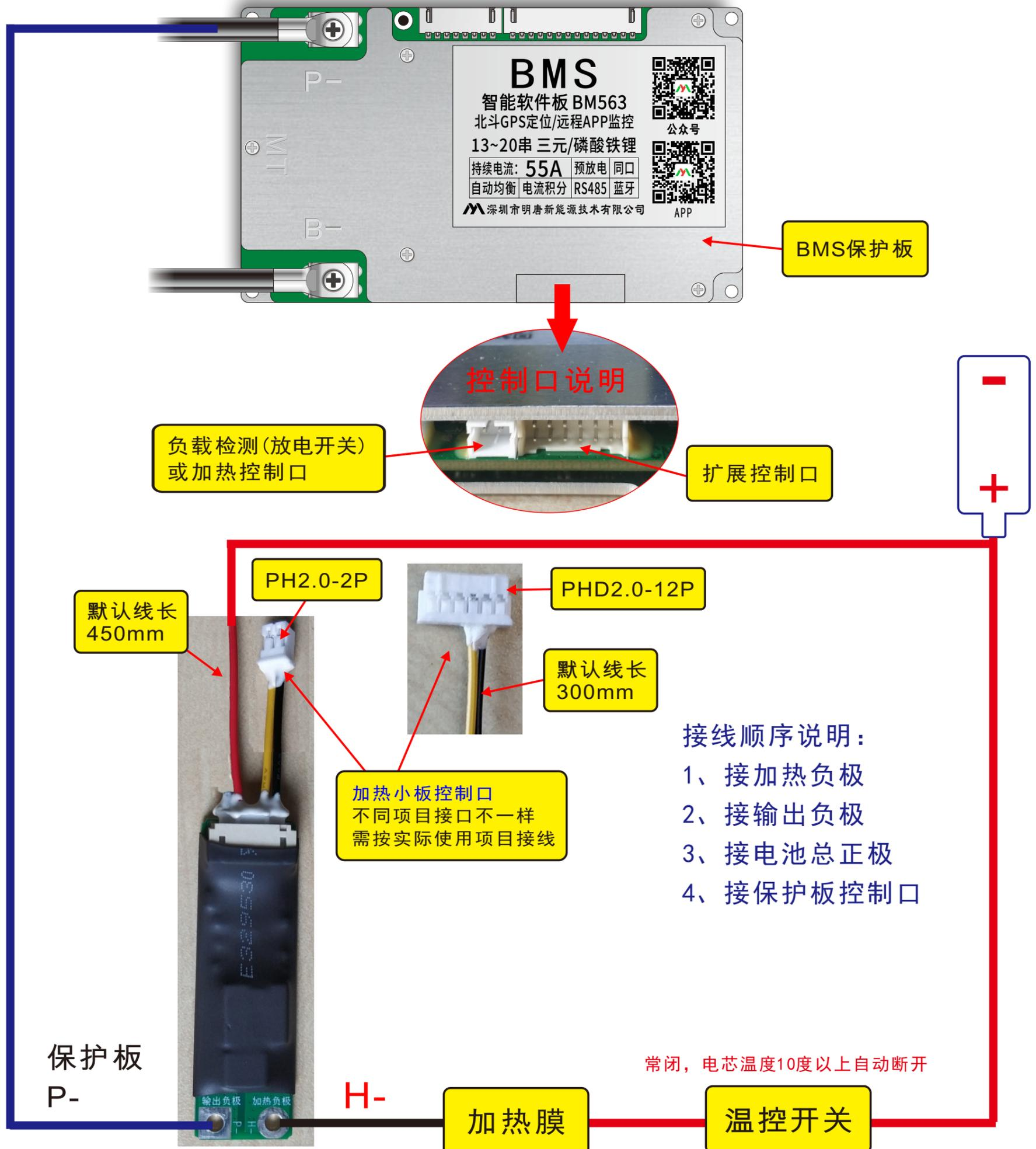
建议检测加热片，温度达到40-50度，自动断开。
